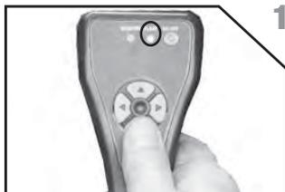
1. Appuyer sur le bouton vers le bas jusqu'à ce que le témoin de Flottement s'allume en bleu.
