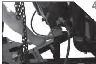
4. Régler la béquille à manivelle jusqu'à ce qu'elle ne soit plus en contact avec le sol.
