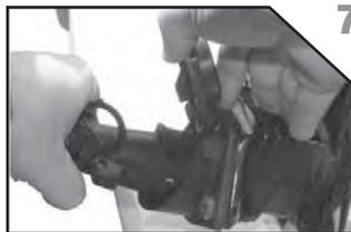
7. Retirer le bouchon de protection de l'extrémité mâle et brancher la prise électrique monobloc. Le bouchon à ressort verrouille la prise monobloc.
