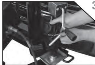
3. Retirer la béquille à manivelle du cadre de relevage.
