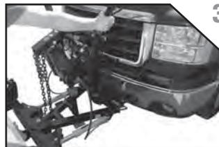
3. Repousser le cadre de relevage jusqu'à ce que les broches s'insèrent dans la fixation du véhicule.
