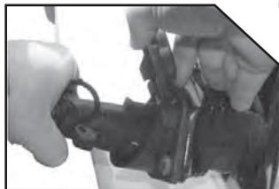
7. Débrancher la prise électrique monobloc et installer le bouchon de protection sur l'extrémité mâle.
