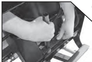
4. Appuyer sur le levier de la béquille et abaisser la béquille jusqu'au sol, puis relâcher le levier.
