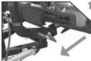
1. Tirer le véhicule dans le dispositif de chasse-neige et pousser le dispositif de chasse-neige de 2,50 à 5 cm vers l'avant.
