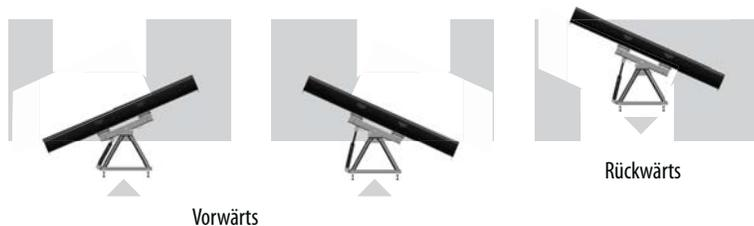
(Abb. 15) 5-Position Lock-n-Go (Arretierung in 5 Positionen)
