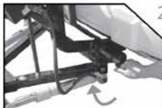
2. Den Griff auf der Fahrerseite drehen, um die Kerbe zu trennen, die die Stifte im offenen Zustand verriegelt.
