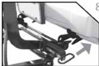
8. Das Fahrzeug von der Schneeräumereinheit zurücksetzen.
