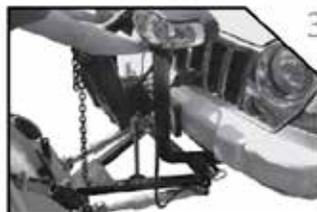
3. Den Handbremsen zurückdrücken, bis die Stifte durch die Halterung am Fahrzeug schnellen.
