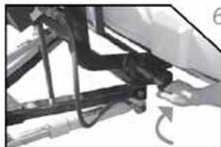
6. Den Griff an der Fahrerseite ziehen, um die Stifte zu trennen, dann drehen, bis die Kerbe die Stifte in der geöffneten Position verriegelt.
